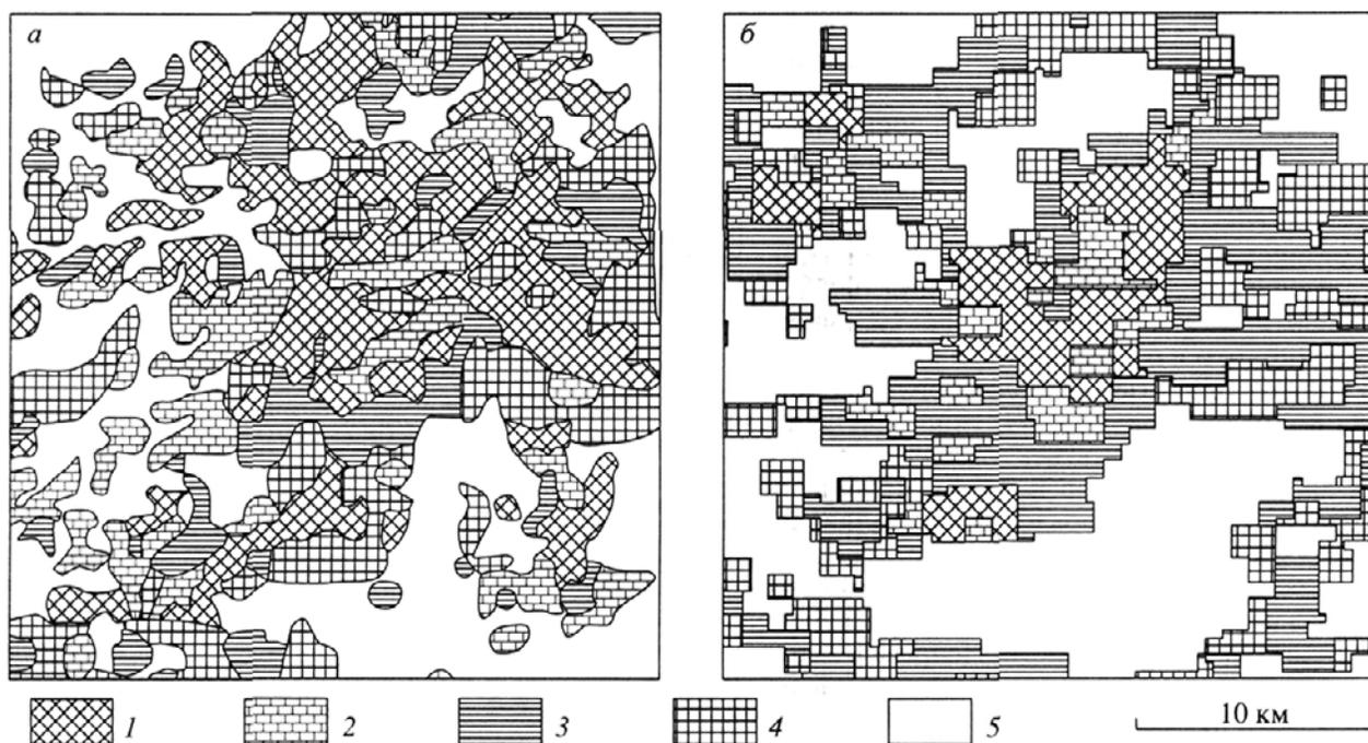
**Рис. 5.** Сопоставление фрагментов снимка AVHRR и исходной карты: *a* - фрагмент карты наземных обследований. *б* - фрагмент картосхемы, построенной по диаграмме (рис. 3); 1 - очень сильные повреждения, 2 - сильные повреждения, 3 - умеренные повреждения, 4 - слабые повреждения, 5 - фон (неповрежденные).
