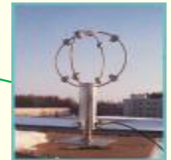
Автоматизированный ультразвуковой метеорологический комплекс МЕТЕО-2
